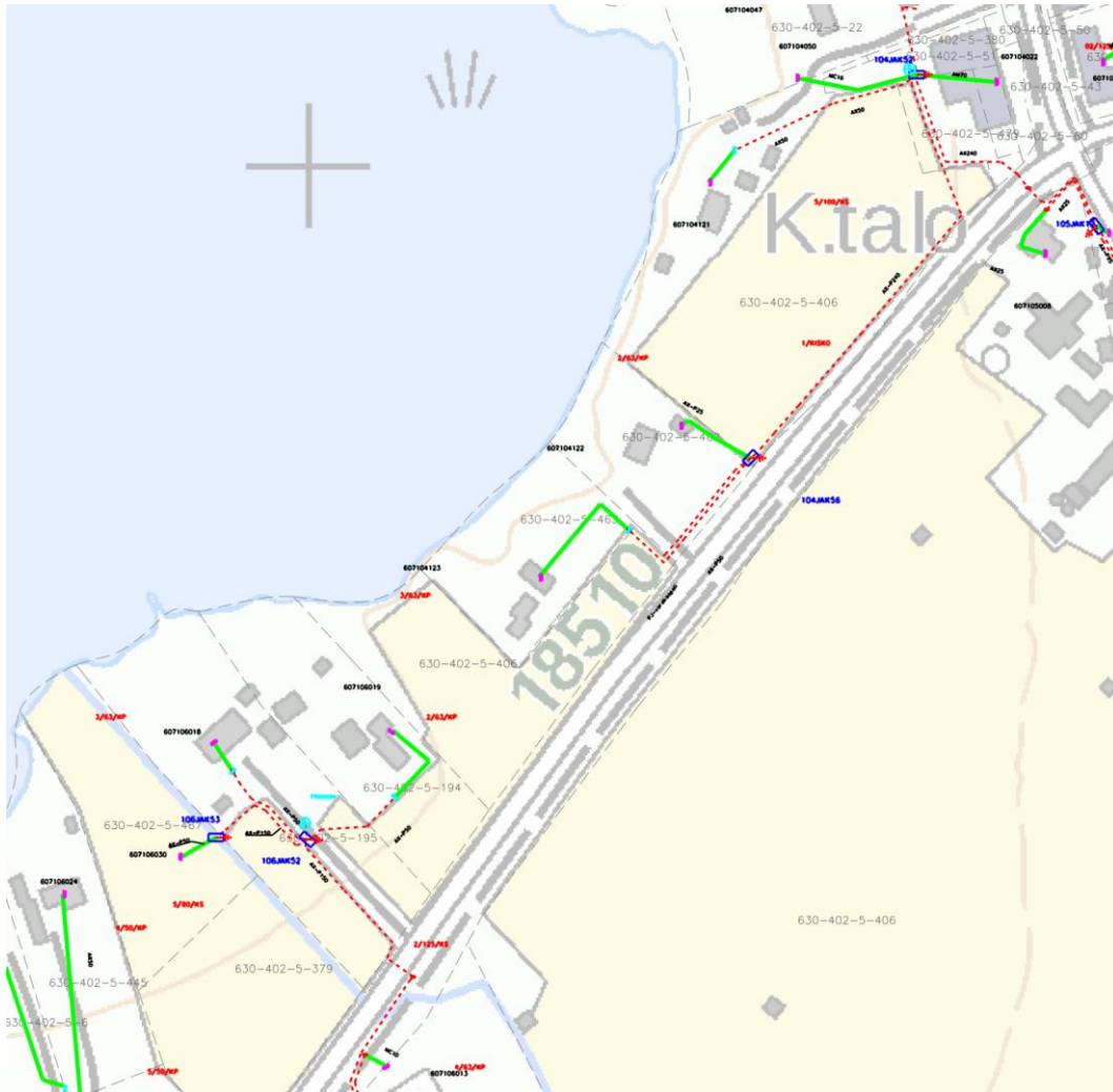
Kajave Oy:n verkostokartta 9/2019. Punaiset kaapelit Kajaven verkkoa ja vihreät asiakkaiden liityntäkaapeleita.
