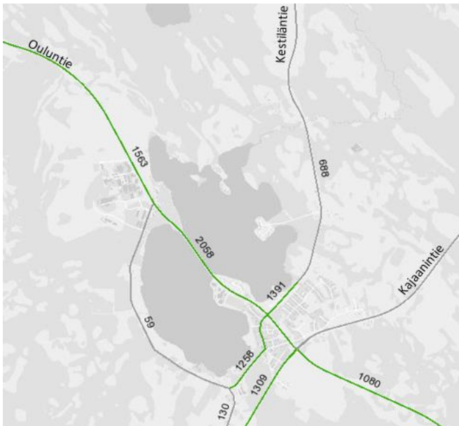
Ote Liikenneviraston liikennemääräkartasta 2015. (ajoneuvoa/vrk); Valta-, kanta-, seutu- ja yhdysteiden keskimääräinen ajoneuvoliikenne (ajon/vrk).
